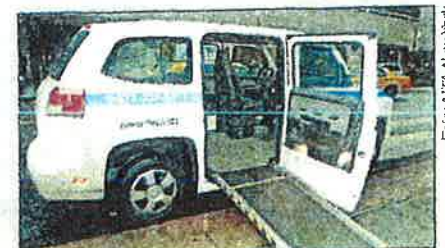
Abb. 5: Rollstuhltaxi mit seitlicher Rampe Modell MV-1.
